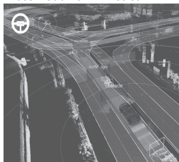
LiDARを使って自己位置推定をしながら 自動運転を実施
