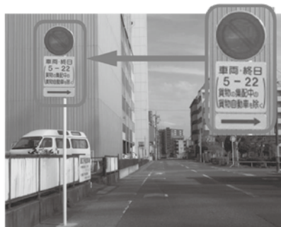
貨物集配中の貨物車に限り駐車規制から除くという規制の実施例
