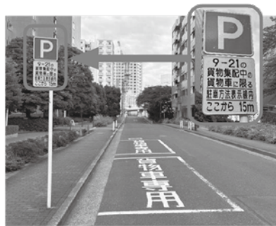
貨物集配中の貨物車に限り駐車可能とする規制の実施例
