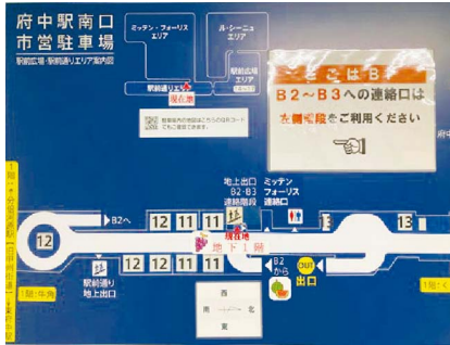
写真3：フロアマップの情報が不足しており、後付けの手作りサインが多い。丸印の「B1」、「B2」、「B3」が、フロア名と認識されない。
