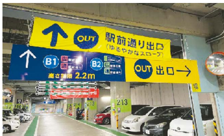
写真14：荷捌きの高さ制限注意を、LED光が流れる赤色バーを設置、他フロア情報を整理、バナーの出口案内をパネル化
