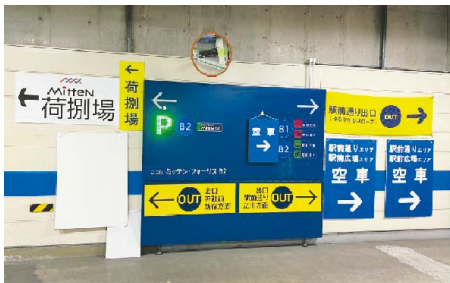
写真11：空車表示を「P」から「空」に改修、ゾーン別カラー表示でゾーニングを明確化、現在地表示を明確化
