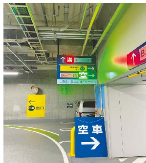
写真8：空車表示を「P」から「空」に改修、ゾーン別カラー表示でゾーニングを明確化、現在地表示を明確化
