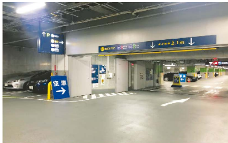
写真7：コンクリートの柱・梁をフロアカラーに塗装し、ここから先が別のゾーンになることを強調した。
