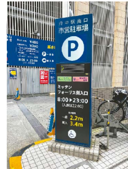
写真4：どの施設の入口かを表示し、さらに駐車ゾーンを色で表示して視認性を高めた。
