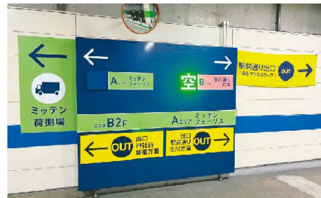
写真11：空車表示を「P」から「空」に改修、ゾーン別カラー表示でゾーニングを明確化、現在地表示を明確化
