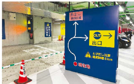
写真13：別フロアの情報削除、ゾーン別カラー表示でゾーニングを明確化、出口表示の明確化
