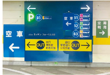
写真2：地下接続先のエリア+別フロアの記載が多すぎる。エリア名称の記載が小さ過ぎて視認性に欠ける。
