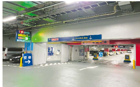
写真7：コンクリートの柱・梁をフロアカラーに塗装し、ここから先が別のゾーンになることを強調した。
