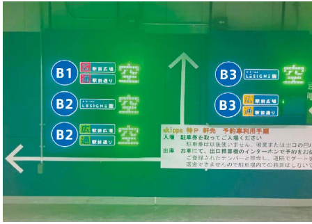
写真1：【ル・シーニュ側入口経由：B3F 入庫ゲート前サイン】満空情報が多過ぎる。エリア名称の記載が視認性に欠ける。
