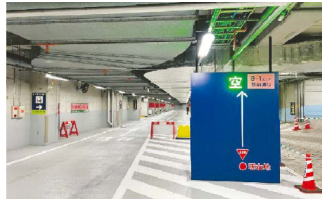
写真10：看板位置と分岐情報の位置が合わず誤解を招くため削除、現在地とゾーンカラーを明確化
