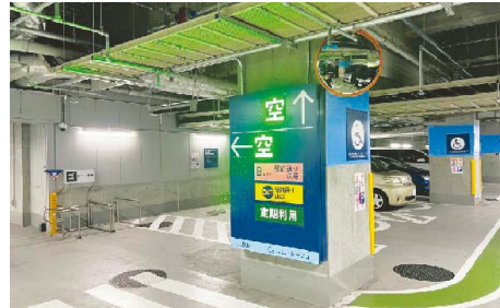
写真9：別フロアの情報削除、ゾーン別カラー表示でゾーニングを明確化、現在地表示を明確化
