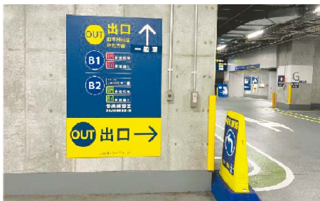
写真12：別フロアの情報削除、ゾーン別カラー表示でゾーニングを明確化、別フロアの情報削除、現在地表示を明確化
