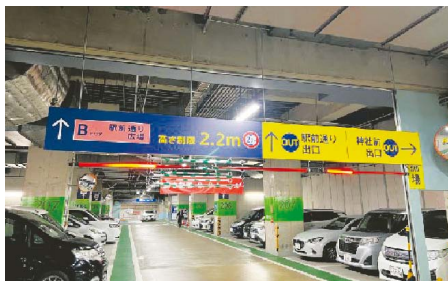
写真14：荷捌きの高さ制限注意を、LED光が流れる赤色バーを設置、他フロア情報を整理、バナーの出口案内をパネル化
