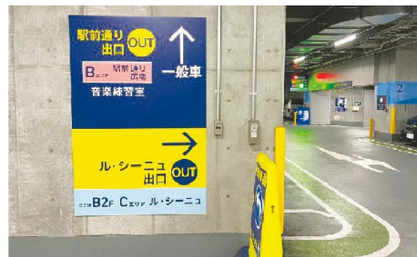
写真12：別フロアの情報削除、ゾーン別カラー表示でゾーニングを明確化、別フロアの情報削除、現在地表示を明確化
