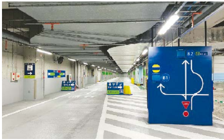
写真10：看板位置と分岐情報の位置が合わず誤解を招くため削除、現在地とゾーンカラーを明確化
